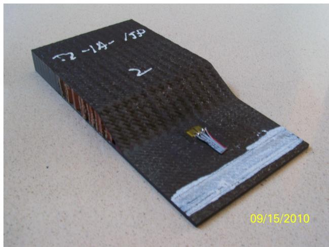
Figura 38. Probeta sándwich de carbono.
