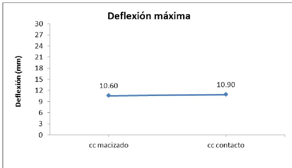
Figura 100. Deflexión máxima para distintas condiciones de contorno.
