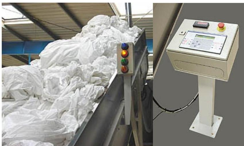
En la figura de la izquierda se ve el conveyor cargado, mientras que en la de la derecha se ven los mandos del conveyor.
