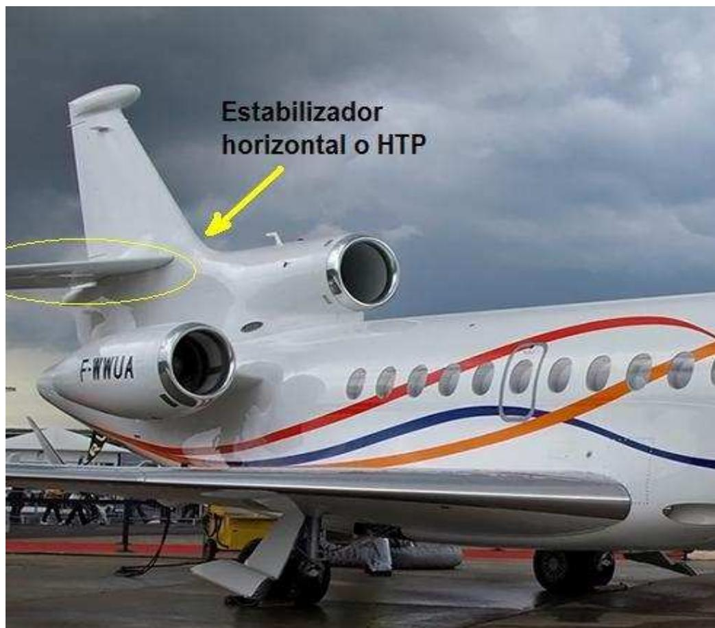
Figura 2.11. Situación del estabilizador horizontal en un jet privado.
