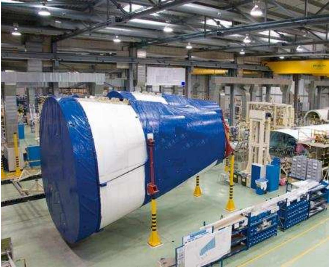
**Figura 2. 8. Sección final de un avión comercial.**
