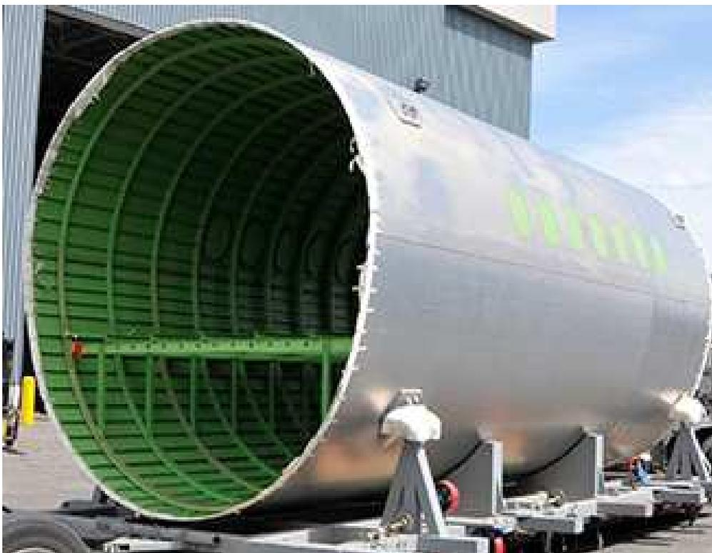
Figura 2.30. Fuselaje exterior típico de sección intermedia.
