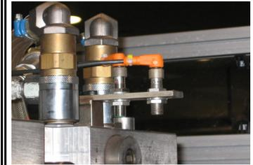
**9.** Verificar el correcto estado del conexionado de los conectores del molde, (cámara caliente, detectores, PLC.)
