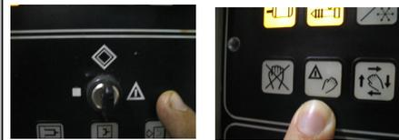
4 Con la máquina en modo ajuste, echaremos hacia atrás el husillo, abriremos el molde y desconectaremos las calefacciones. Fijaremos la velocidad de apertura del molde en el monitor.
