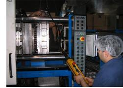
38 Movemos la prensa hasta cerrar el molde completamente.
