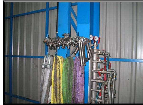
PREPARACIÓN DE TABLERO SOPORTE HERRAMIENTAS Y GANCHOS SOPORTES PARA ESLINGAS
