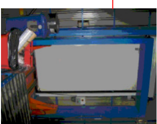
PUERTA AUTOMÁTICA ENTRADA PALETS
