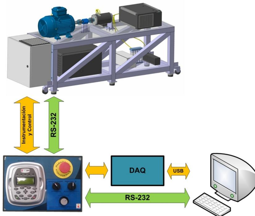
Figura 95. Esquemas de conexiones
