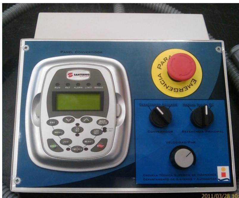
Figura 96. Imagen del panel del operador terminado
