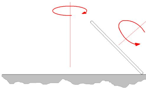
“El sistema se encuentra inclinado respecto a la superficie de contacto, girando respecto a dos ejes, uno perpendicular al plano que define el sistema aro-barra y el otro perpendicular a la superficie de contacto”.
