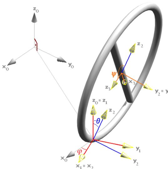
Fig.2 – Definición de los sistemas de referencia y ángulos.
