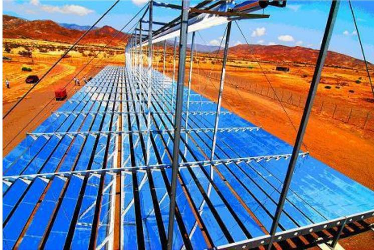
Figura 6. Concentrador lineal tipo Fresnel.
