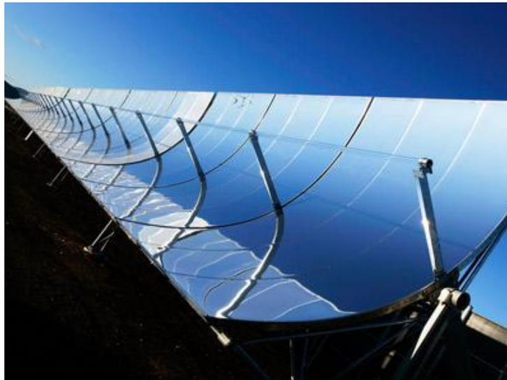
Figura 5. Captador cilindro parabólico.
