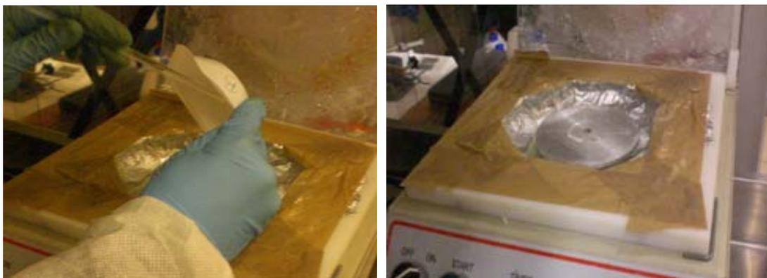
Figura 5.7. Deposición del PDMS sobre acetato en Spin Coater.
