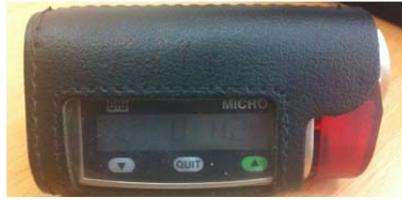
**Ilustración 59 - Detector de fugas de H2 portatil**
