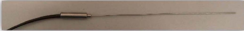
**Ilustración 38 - Termopar tipo T**
