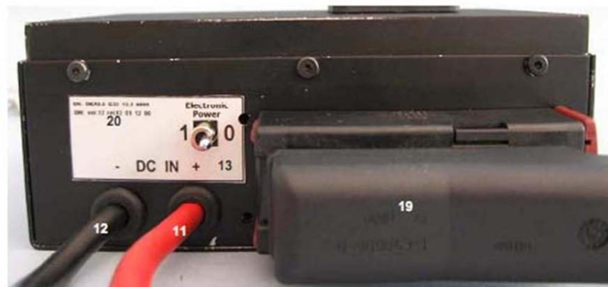
Ilustración 7 - Imagen de la unidad electrónica de control con sus diferentes partes indicadas.
