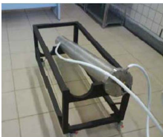
Ilustración 69 - Depósito de hidruros metálicos
