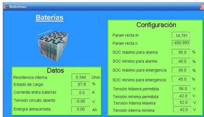
Ilustración 91 - Subpantalla de supervisión y configuración de baterías
