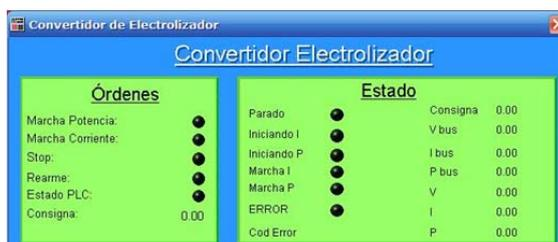
**Ilustración 89 - Subpantalla del convertidor del electrolizador**
