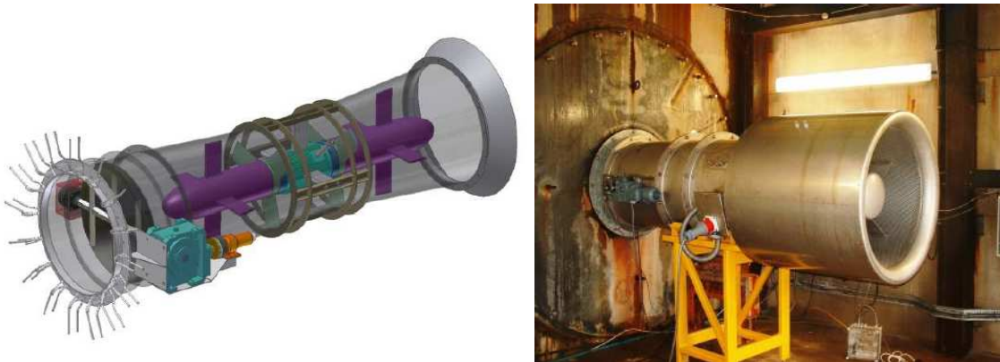
Figura 4.15: Turbogenerador de la planta de Mutriku [4.17]
