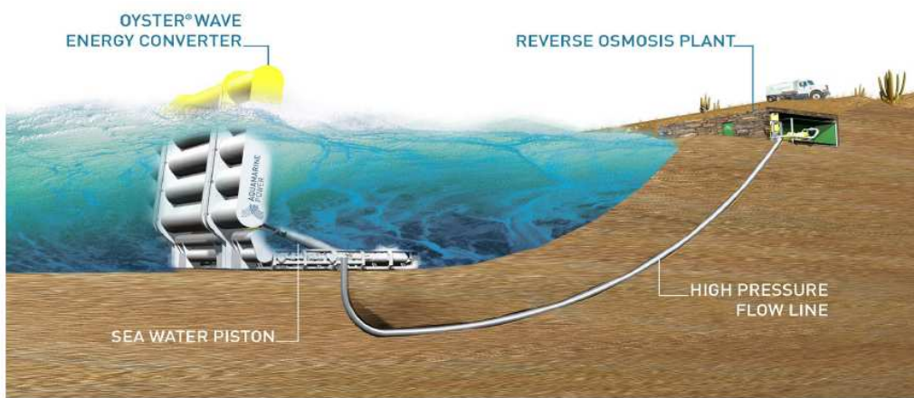
Figura 4.36: Esquema instalación del dispositivo Oyster [4.27]
