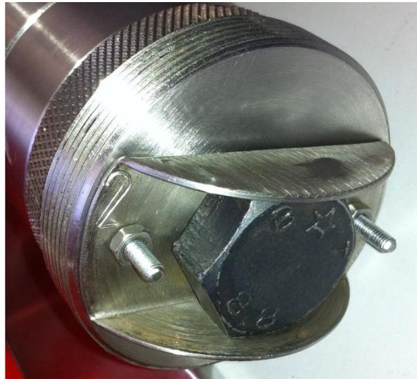
Figura 28: Chapa fija tornillo
