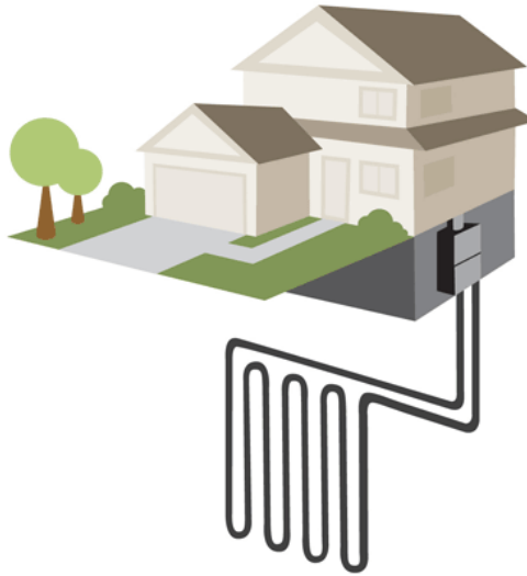
Figura 15.- Integración en la edificación de red vertical [2].
