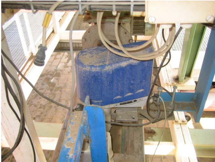
**Figura 4.4 - Sensor de humedad de salida.**
