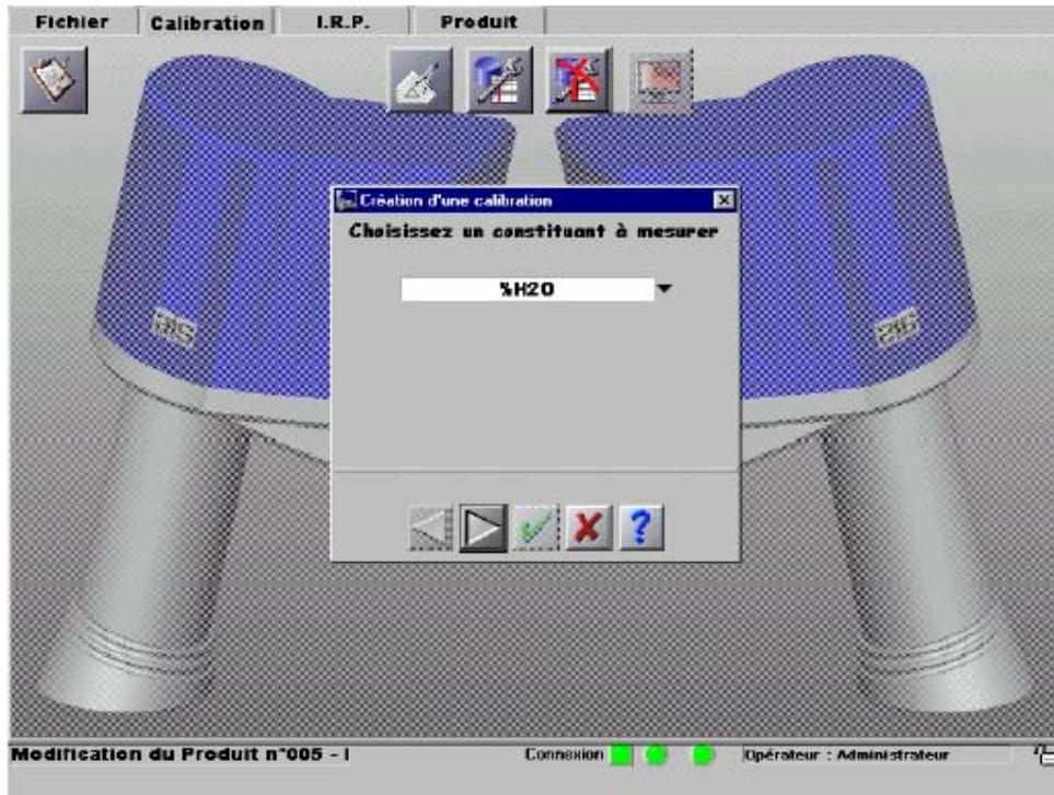
Ahora se debe seleccionar la medida o referencia que se desea calcular en la nueva calibración. En este caso se tiene humedad (%H<sub>2</sub>O) y también se puede obtener una estimación del caudal de arena (arena).
