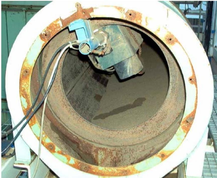
Figura 4.2 - Sensor de humedad de entrada
