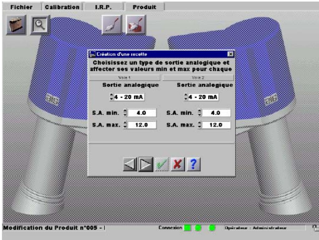
La señal de trabajo es la “Voie 1”, con lo cual la vía 2 no es necesario ajustarla. Primero se coloca el tipo de señal de salida, en nuestro caso es 4-20 mA, y seguido se da el valor de la medida que corresponde a la salida analógica mínima y máxima. Después de observar que la señal mandada por el sensor era bastante inferior a los 4mA que debía mandar, se optó por invertir el mínimo y el máximo, es decir:
