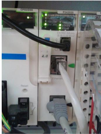
Figura 5 – 1 M340 CPU. Conexiones de red
