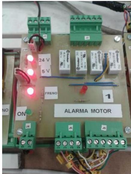
Figura 5 – 8 Módulo adaptador de señales
