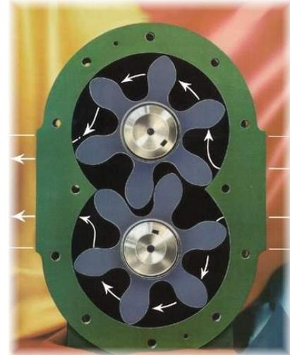
Fig.1.14- Ejemplo de bomba de engranajes empleada en los frenos hidráulicos.
