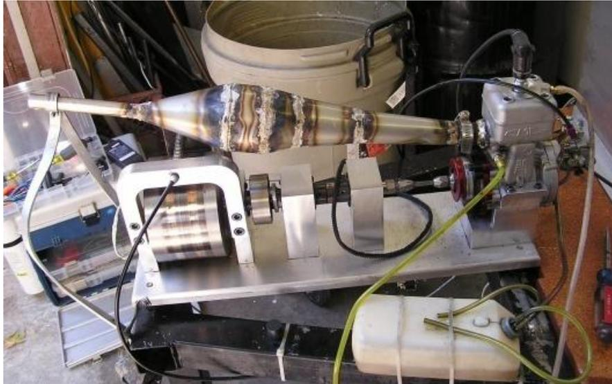
Fig.1.12- Disposición de un pequeño banco de ensayos inercial para un motor de 35cc de aplicación en modelismo.
