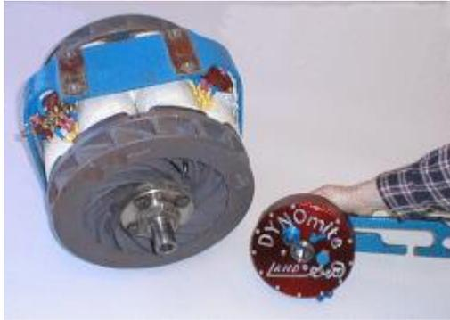
Fig.1.16- Comparativa entre freno Eddy (300 libras) y de agua (8 libras) para capacidades energéticas similares. La diferencia de masa y volumétrica es notable.
