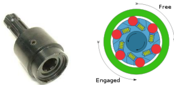
Fig.-2.3- Ejemplo de embrague de sobre régimen.
