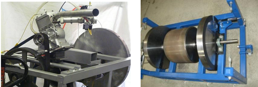
Fig.-2.4- Ejemplo de construcciones tubulares de bancos de ensayo inerciales
