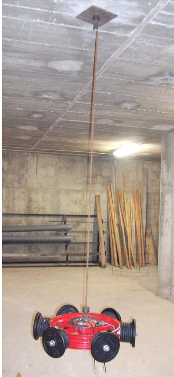
Fig. 3.8 – Ensamblaje final del volante para la medida de la Inercia.
