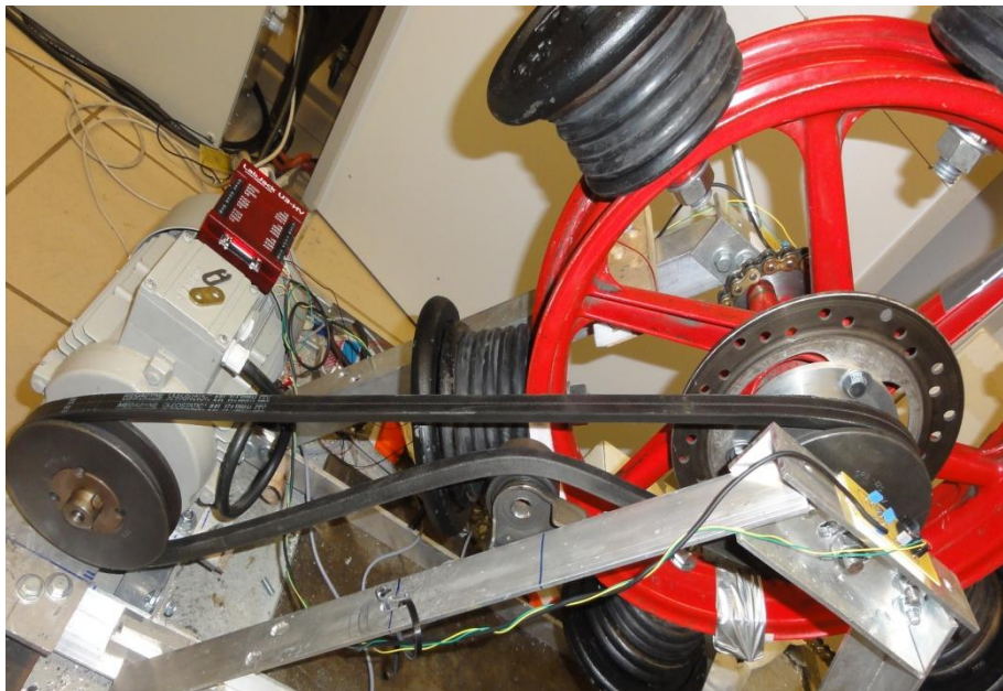
Fig.4.4.- Se muestra el montaje específico para la puesta a punto de sistema de adquisición de datos, y el equilibrado del rotor. Tanto el motor eléctrico, como ambas poleas, la correa y el tensor de la misma provienen de un banco de ensayos de rodamiento, y se han adaptado a la estructura portante del banco.
