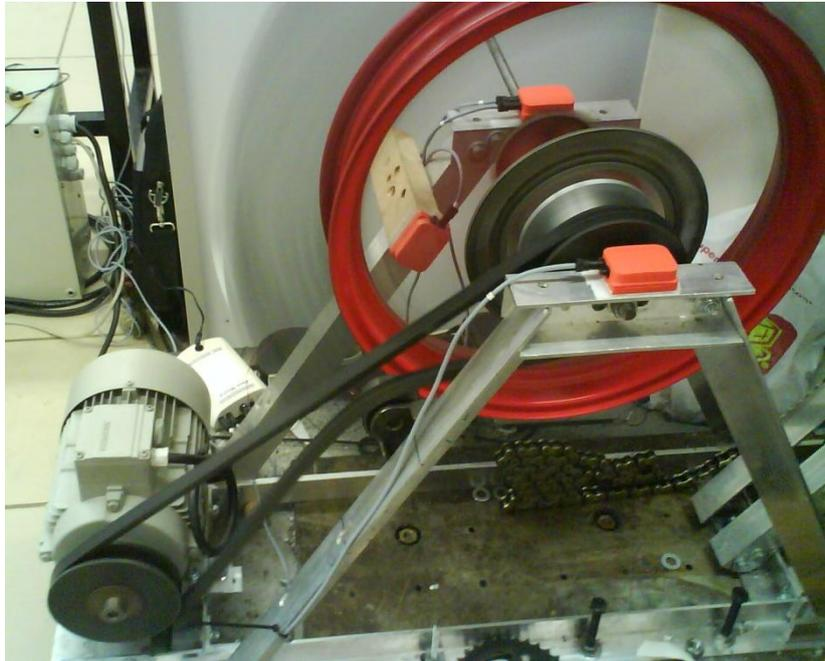
Fig.5.7.- Situación de los 3 sensores MTi en funcionamiento durante la toma de medidas del equilibrado.
