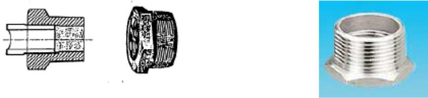
Figura 3.45 - Reducción buje roscada
