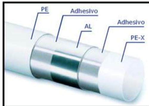
Figura 4.16 – Tubería multicapa (12)
