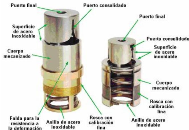
Figura 9.22 – Cartucho de una válvula de equilibrado dinámico
