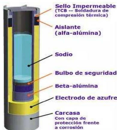
Figura 2.12. Principales Partes de una celda de Sodio-azufre.
