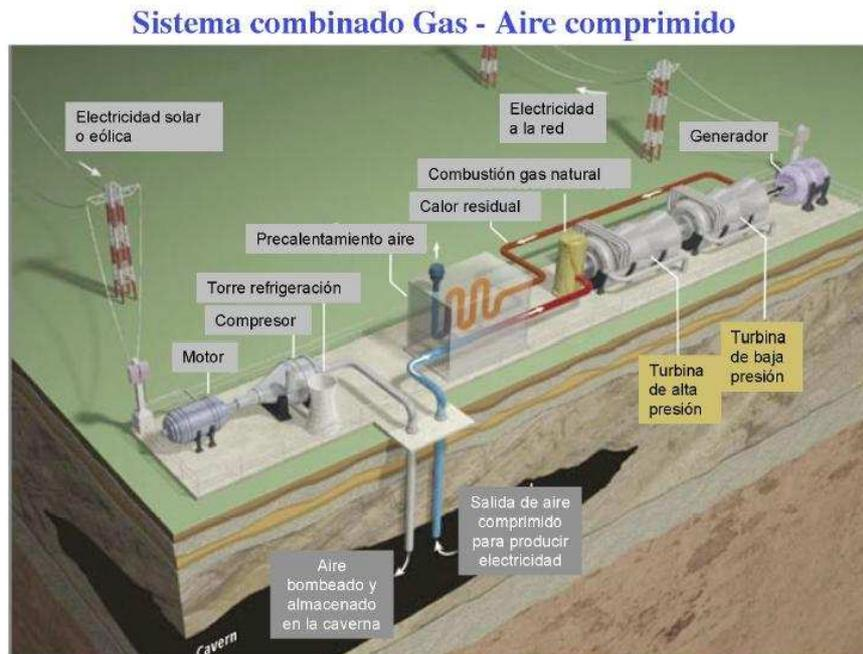
Figura 2.5. Esquema de funcionamiento de planta CAES (Sistema Híbrido) [1].
