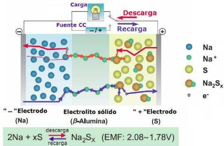
Figura 2.11. Celda electroquímica de la Batería de NAS.
