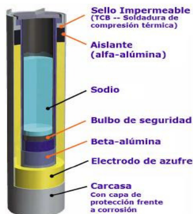
Figura 2.12. Principales Partes de una celda de Sodio-azufre.
