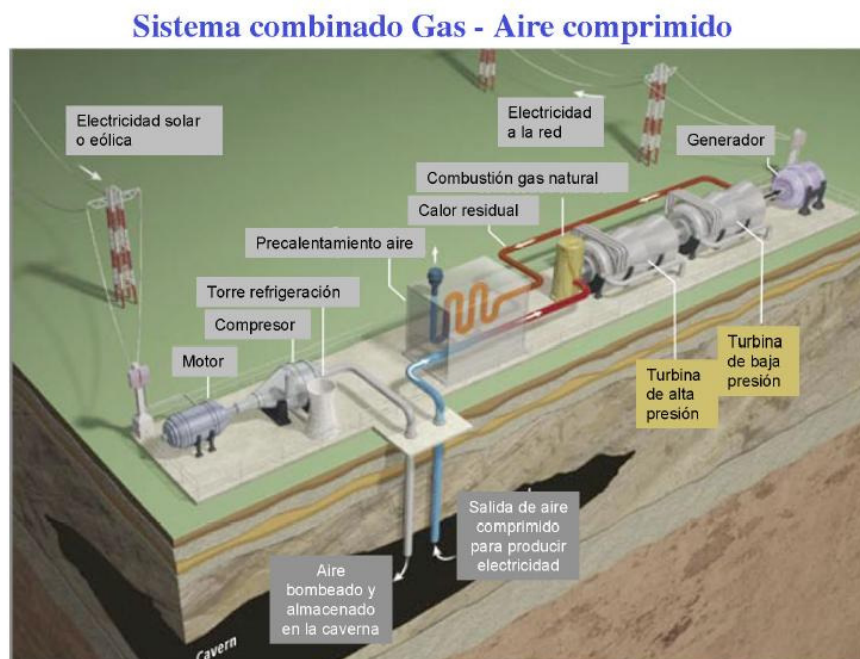
Figura 2.5. Esquema de funcionamiento de planta CAES (Sistema Híbrido) [1].
