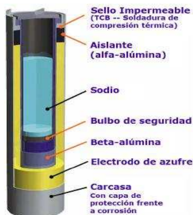
Figura 2.12. Principales Partes de una celda de Sodio-azufre.
