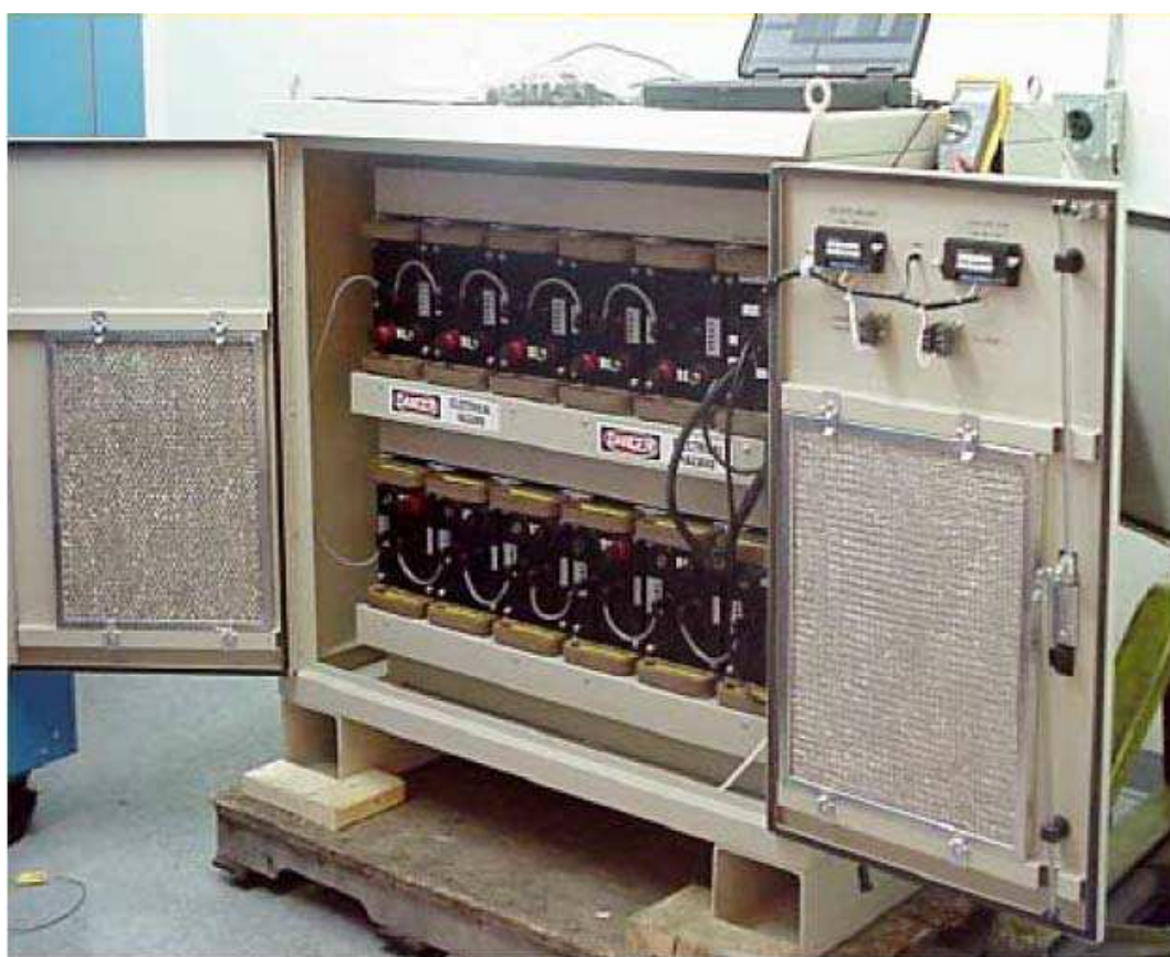
Figura 2.14. Sistema de almacenamiento Li-Ion de 100kW.
