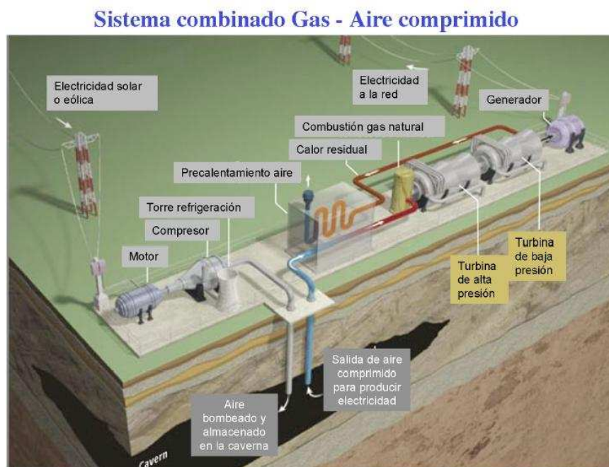
Figura 2.5. Esquema de funcionamiento de planta CAES (Sistema Híbrido).
