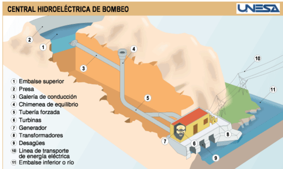
Figura 2.1. Central de bombeo [29].
