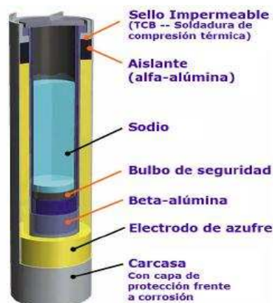
Figura 2.12. Principales Partes de una celda de Sodio-azufre.
