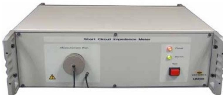
**Figura 4. 4. Unidad de medida de impedancia de cortocircuito. Fuente: Unitronics.**
