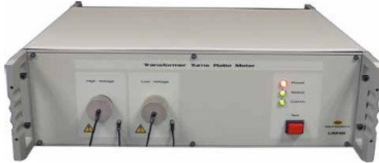
**Figura 4. 3. Unidad de medida de relación de transformación trifásica. Fuente: Unitronics.**
