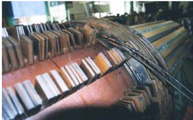
**Figura 4. 1. Perforación del sistema dieléctrico en la columna de un transformador de potencia. Fuente: Talleres Eléctricos Molina, Córdoba.**
