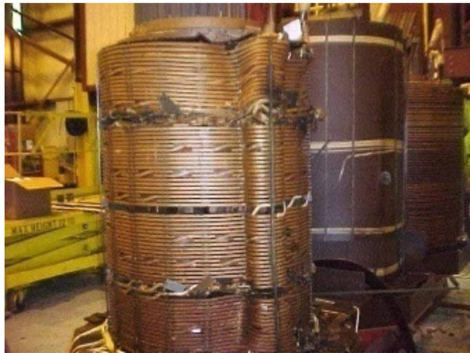
**Figura 4. 7. Fotografía del devanado derrumbado y conexiones flojas en el transformador. Fuente: Unitronics.**
