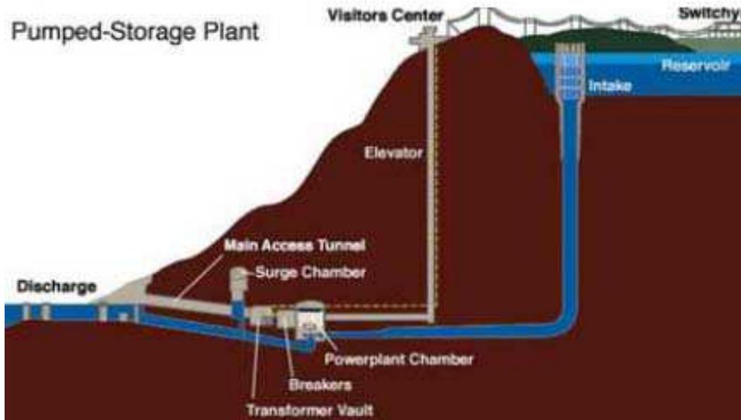
**Figura 12.-** Esquema típico de una central de bombeo.
