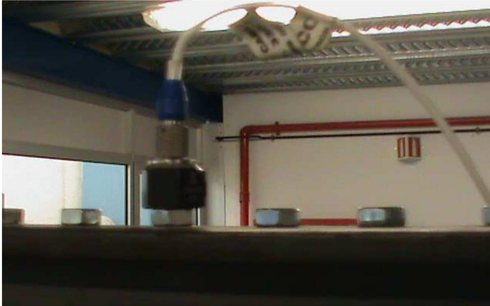
*Figura 4. Acelerómetro piezoeléctrico roscado a tuerca*
