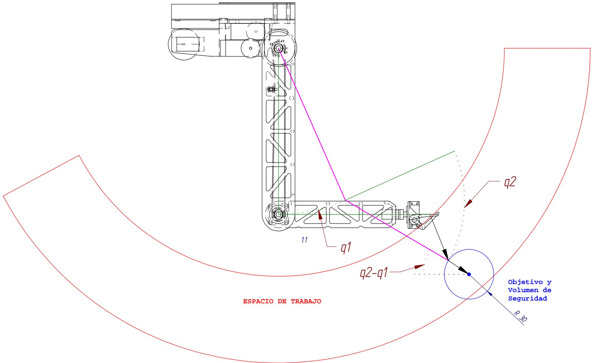
*Posición de aproximación de forma que la pinza abierta quede orientada para coger el objetivo sin colisionar con él.*
