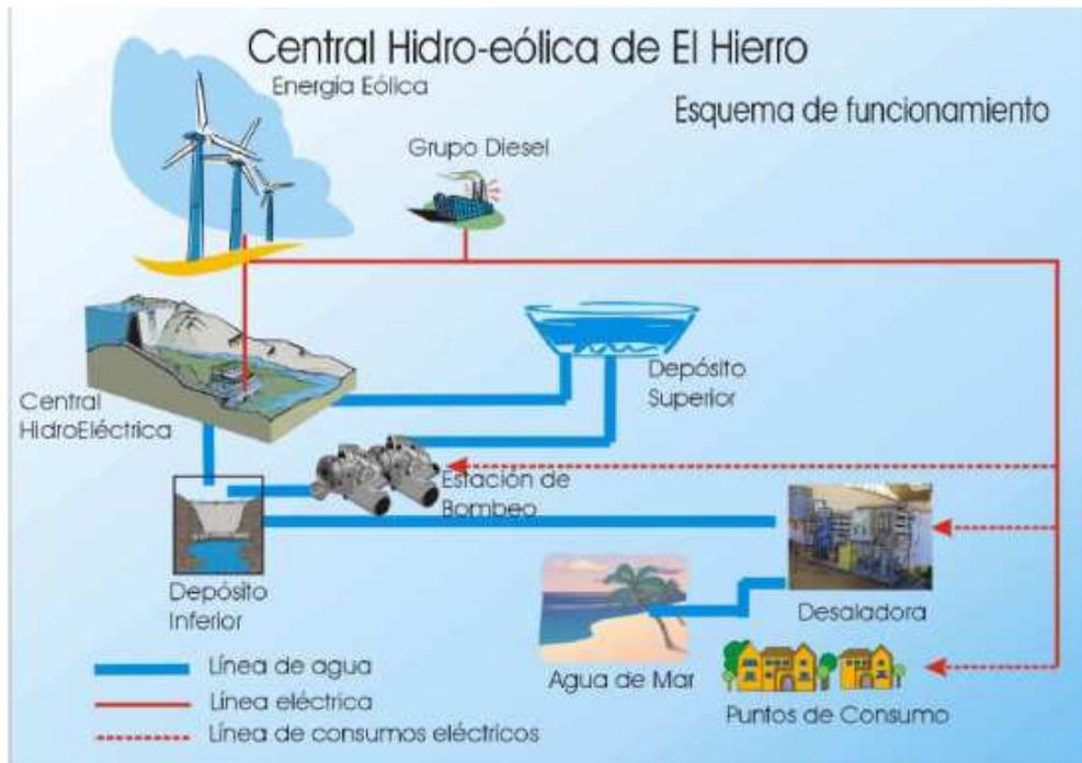
Figura 1.10. Esquema de funcionamiento [10].
