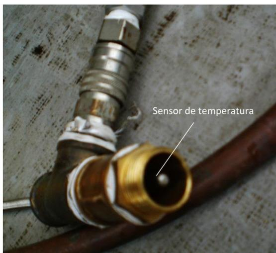
**Figura 69:** Detalle sensor de temperatura usado en el bloque de ensayos altas temperaturas.
