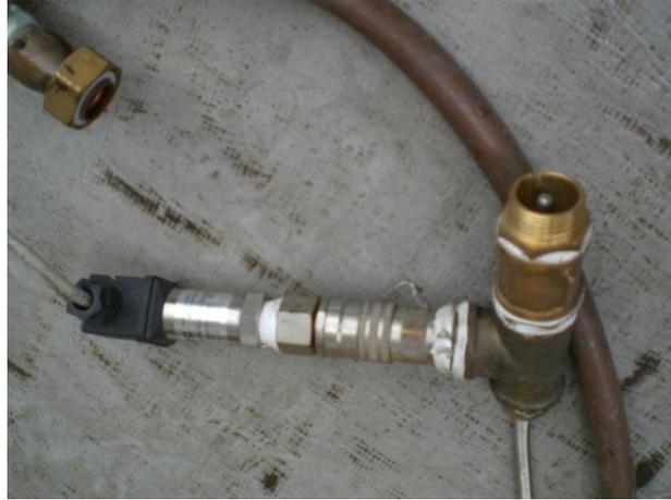
**Figura 91:** Estado del tubo interior de silicona y exterior de cobre tras el ensayo 7.
