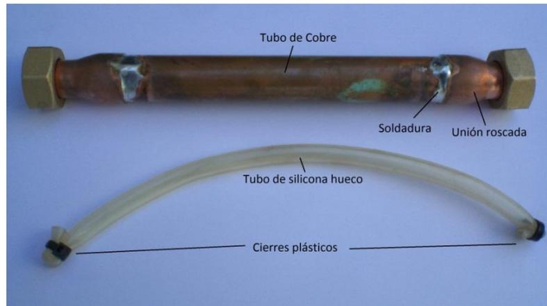
**Figura 66:** Preparación tubos cobre y silicona para los distintos experimentos.
