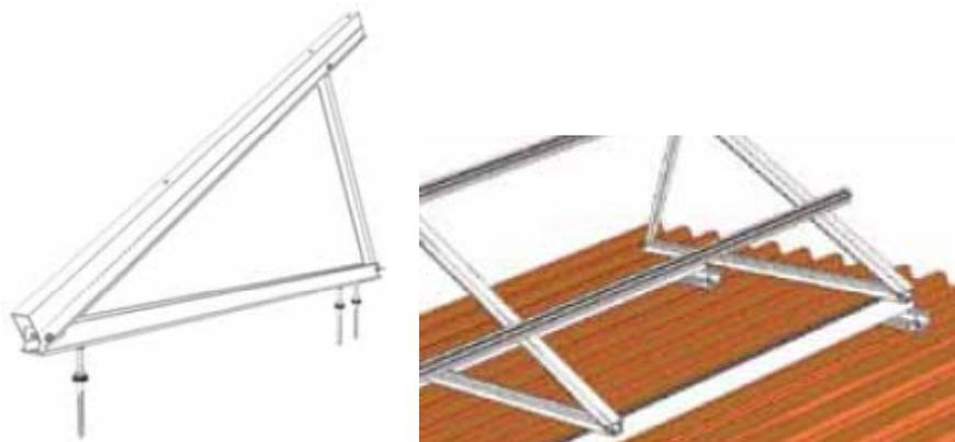
*Figura 7.2: Detalle unión contrapeso y vigas horizontales.*
