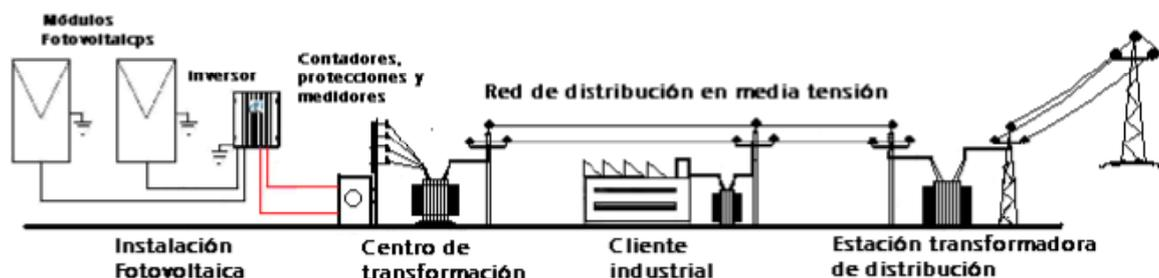
Figura 2.1: Componentes instalación conectada a red
