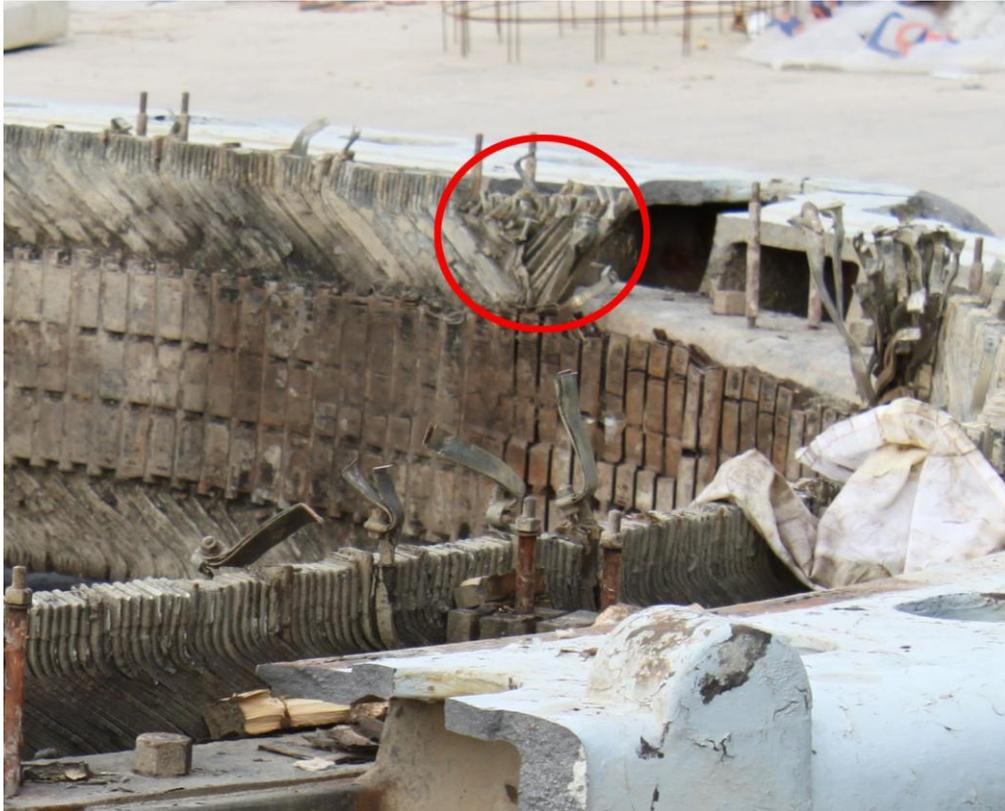
Detalle del bobinado en dos capas del estator de la máquina de Van Der Kerchove
