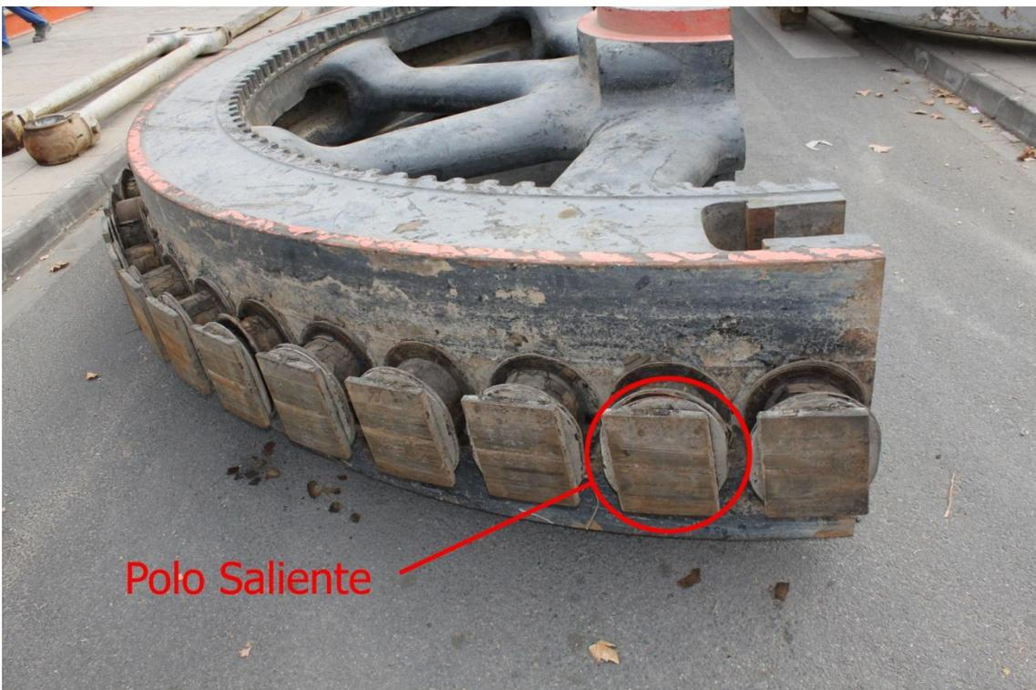
Detalle de un polo saliente del rotor
