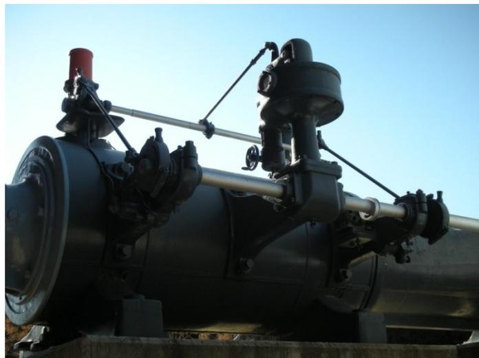
Imagen donde se puede ver el sistema de válvulas y regulador de la máquina de Van Der Kerchove
