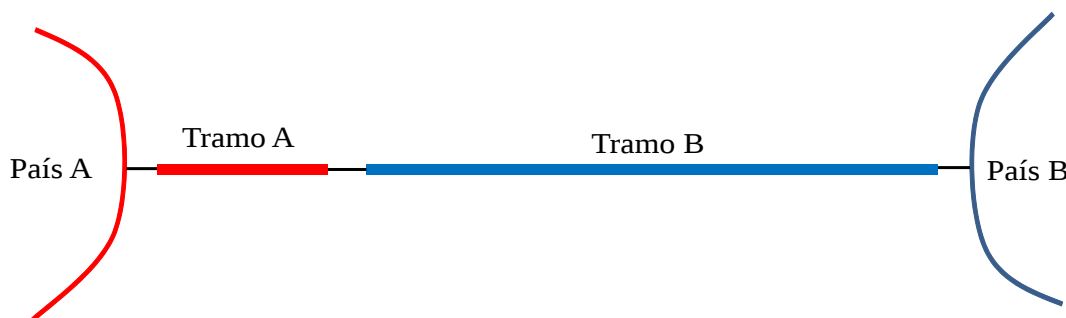
Figura 31. Croquis del sistema de transmisión sin la presencia de un parque eólico marino
