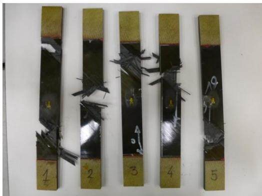
**Figura 3-14.** Probetas de tracción.
