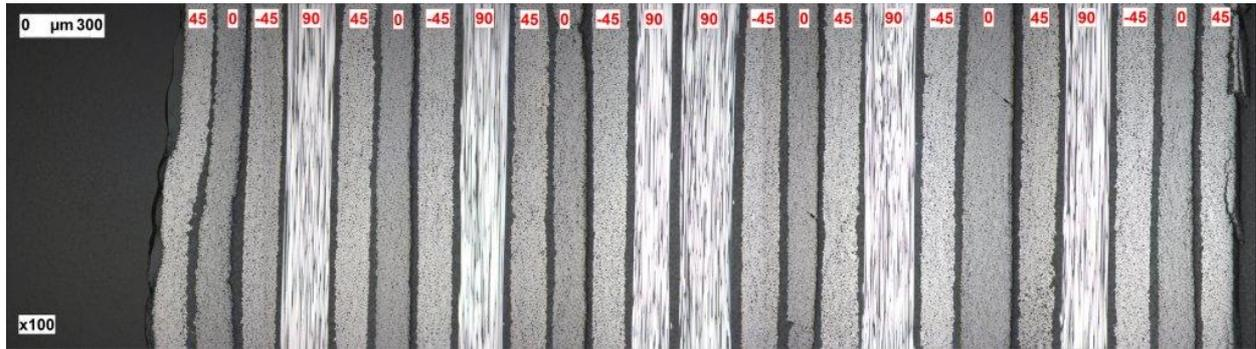
**Figura 3-20.** Micrografía de la secuencia de apilado del laminado B.
