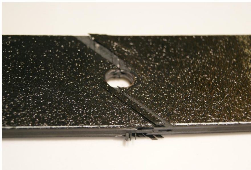
Figura 4-13. Superficie de rotura para ratio 5 del laminado A. (II)
