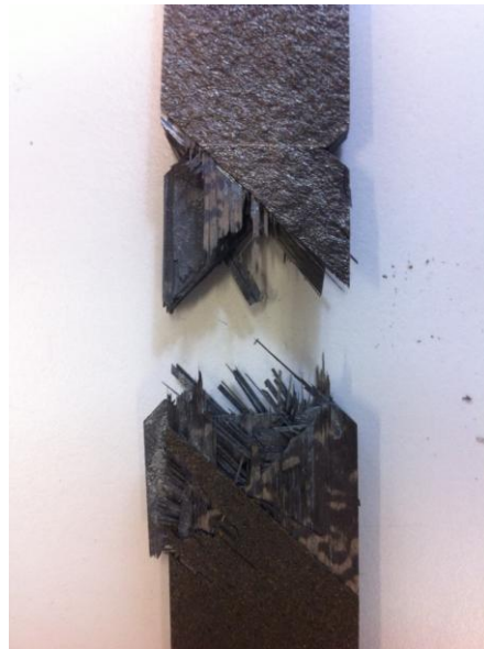
Figura 3-32. Rotura de la probeta DENT para el laminado A.
