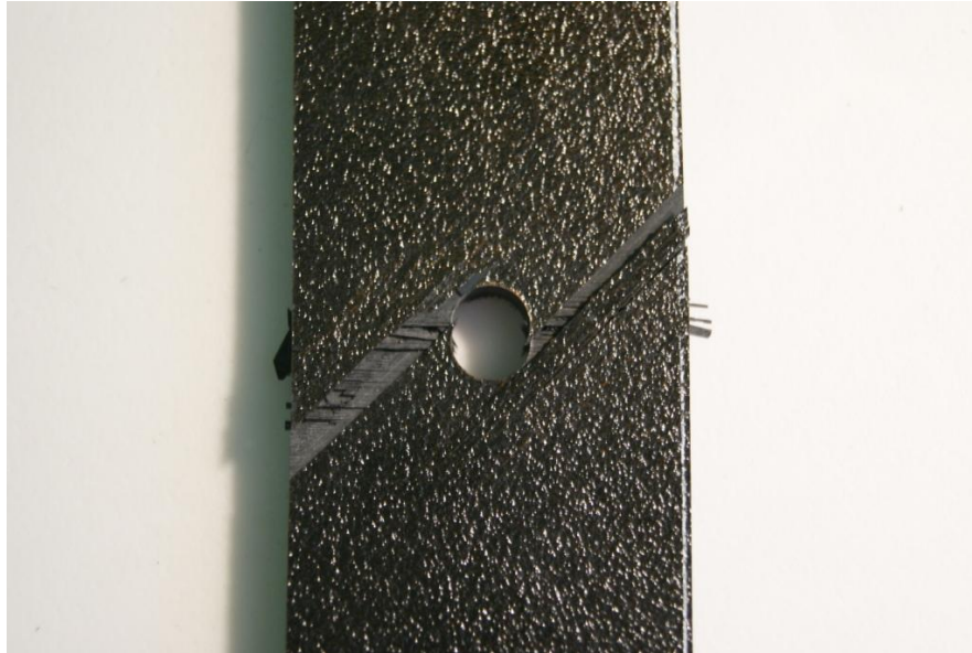
Figura 4-12. Superficie de rotura para ratio 5 del laminado A.
