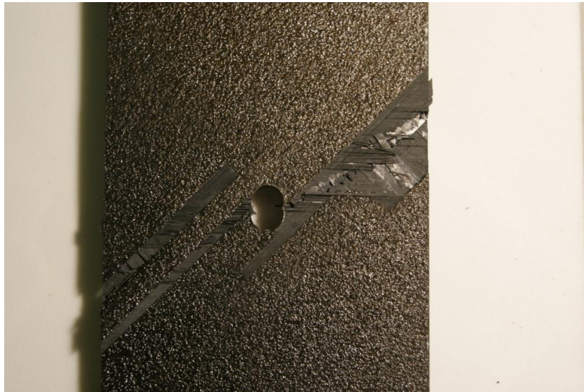
Figura 4-10. Superficie de rotura para ratio 10 del laminado A.
