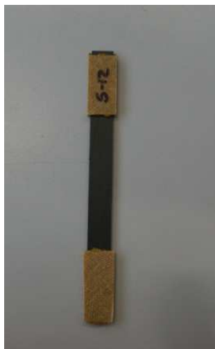
Figura 3. 5: Probeta de ratio 6 y espesor 1mm, con designación 5-12
