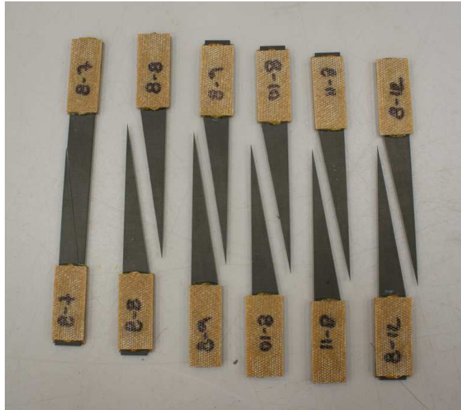
Figura 3. 17: Probetas 8-7, 8-8, 8-9, 8-10, 8-11 y 8-12 de ratio 6 y espesor 1mm ensayadas
