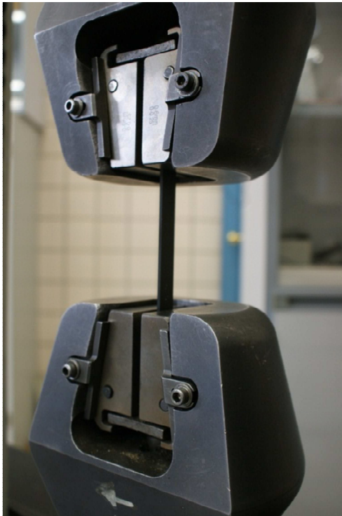
Figura 3. 10: Sistema de cogida mediante mordazas tipo cuña
