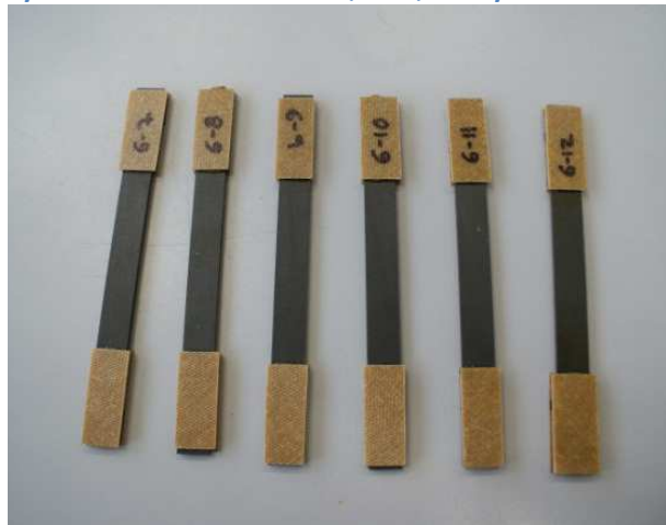
Figura 3. 4: Probetas de ratio 6 y espesor 2mm, con designación 6-7, 6-8, 6-9, 6-10, 6-11 y 6-12
