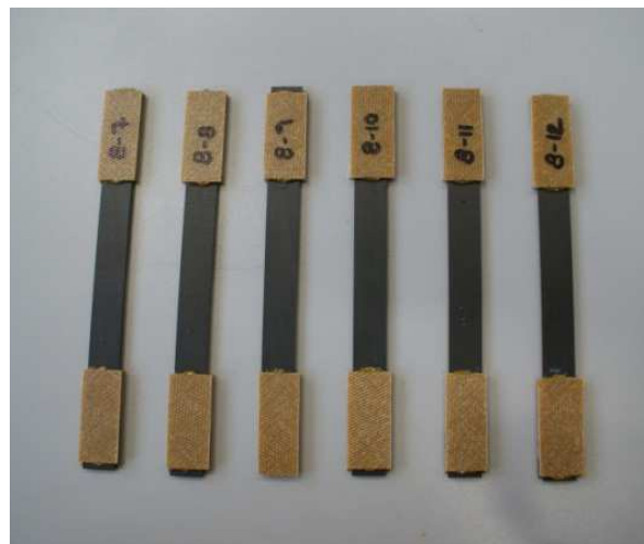
Figura 3. 6: Probetas de ratio 6 y espesor 1mm, con designación 8-7, 8-8, 8-9, 8-10, 8-11 y 8-12
