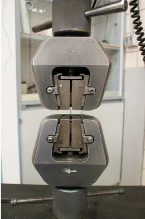
Figura 3. 23: Sistema de cogida mediante mordazas tipo cuña en espécimen de ratio 3
