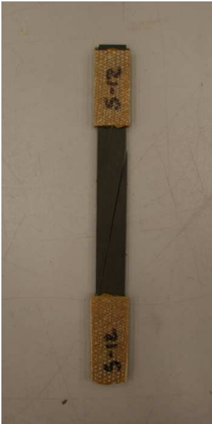
Figura 3. 16: Probeta 5-12 de ratio 6 y espesor 1mm ensayada
