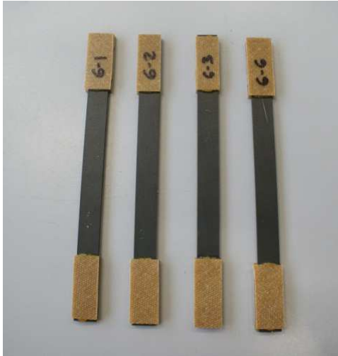
Figura 3. 2: Probetas de ratio 8 con designación 6-1, 6-2, 6-3 y 6-6
