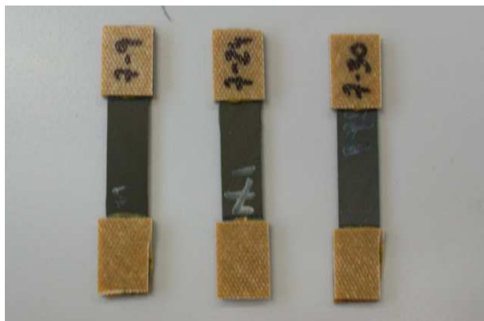
Figura 3. 21: Probetas de ratio 3 con designación 7-7, 7-24 y 7-30
