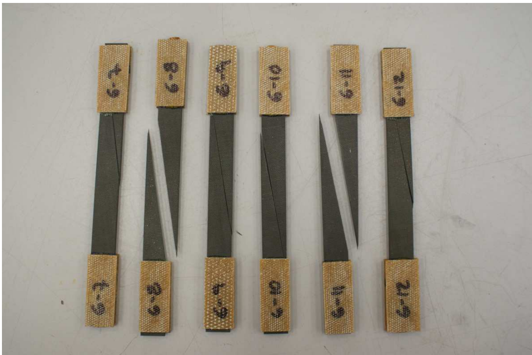
Figura 3. 15: Probetas 6-7, 6-8, 6-9, 6-10, 6-11 y 6-12 de ratio 6 y espesor 2 mm ensayadas
