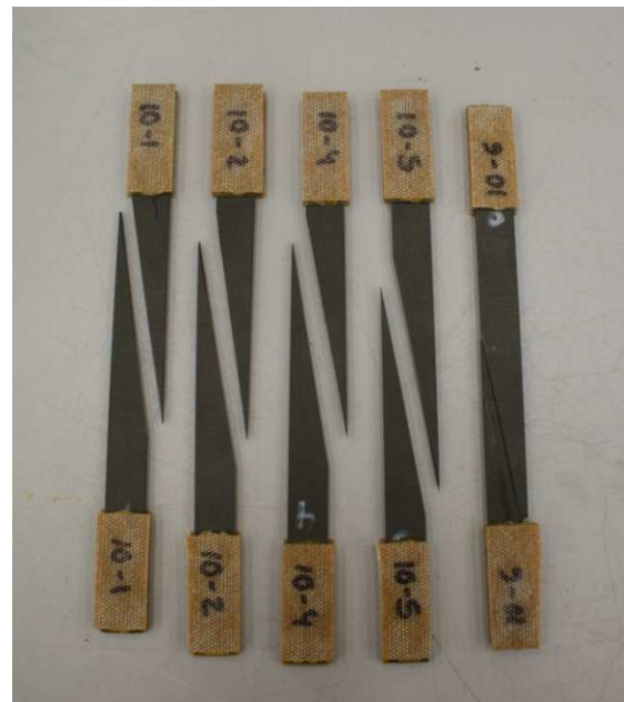
Figura 3. 13: Probetas 10-1, 10-2, 10-4, 10-5 y 10-6 de ratio 8 ensayadas
