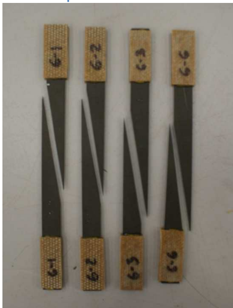
Figura 3. 12: Probetas 6-1, 6-2, 6-3 y 6-6 de ratio 8 ensayadas
