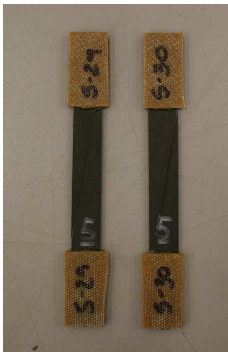
Figura 3. 19: Probetas 5-29 y 5-30 de ratio 5 ensayadas
