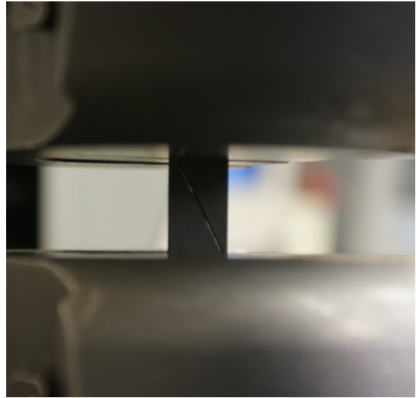
Figura 3. 24: Rotura de probeta de ratio 3
