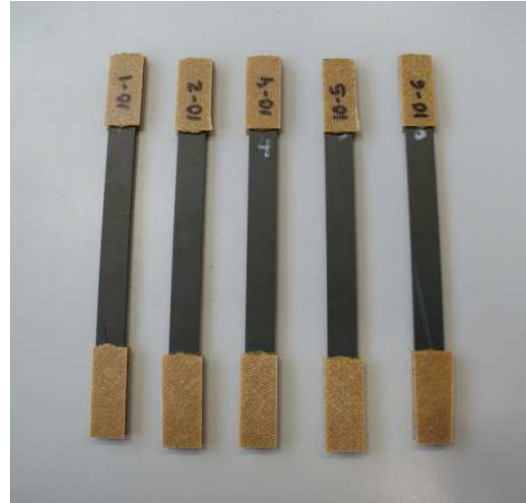
Figura 3. 3: Probetas de ratio 8 con designación 10-1, 10-2, 10-4, 10-5 y 10-6
