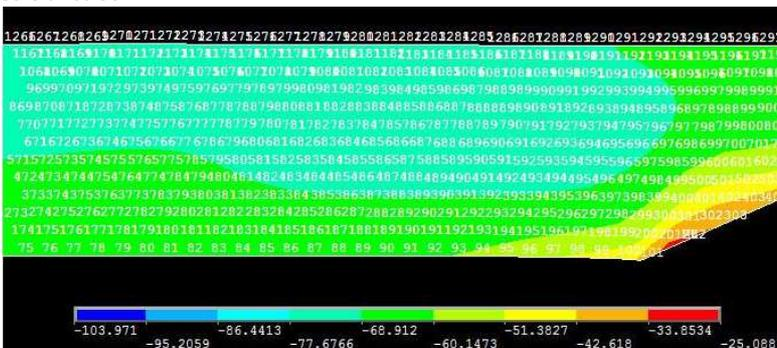
Figura 5. 18: Detalle del campo de tensiones de  $\sigma_{12}$  para el fallo lateral en probeta de tacones oblicuos
