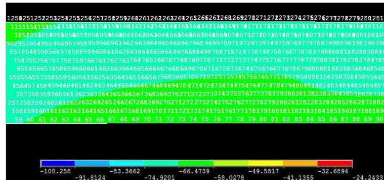
Figura 5. 17: Detalle del campo de tensiones de  $\sigma_{12}$  para el fallo centro-lateral en probeta de tacones oblicuos
