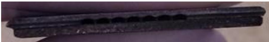
**Figura 35. Canales del microreactor de ACX 845 a 5 kN, 950°C, 8h**
