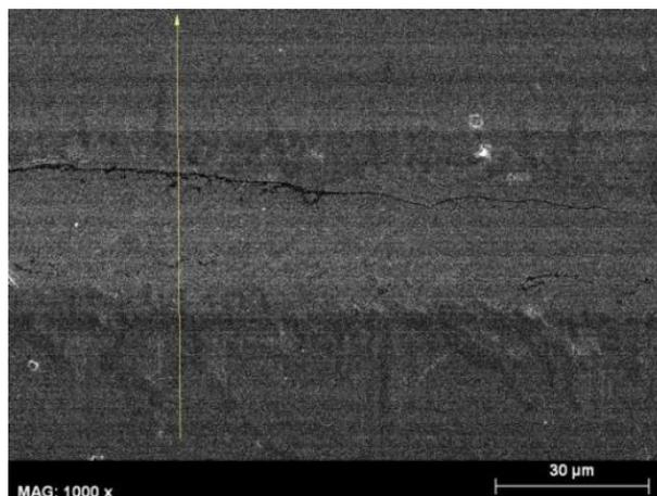
**Figura 56. Zona para el análisis en línea de la zona soldada del microreactor de feccralloy a 26 kN**
