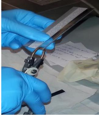
**Figura 8. Soldando por puntos el vidrio metálico a la lámina mecanizada**
