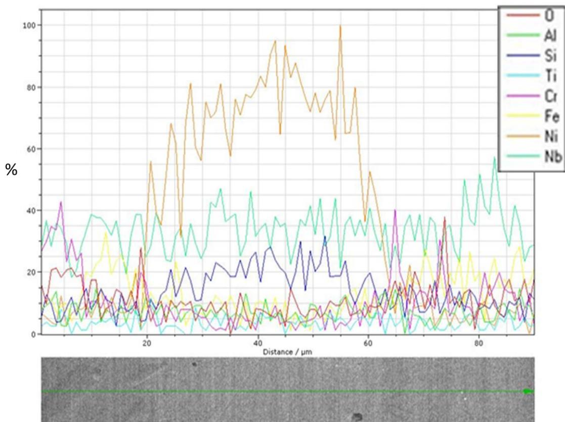
**Figura 33. Análisis en línea de la zona soldada del microreactor de ACX 845 a 14 kN**
