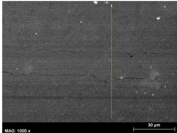
**Figura 62. Zona para el análisis en línea de la zona soldada del microreactor de feccralloy a 15 kN**
