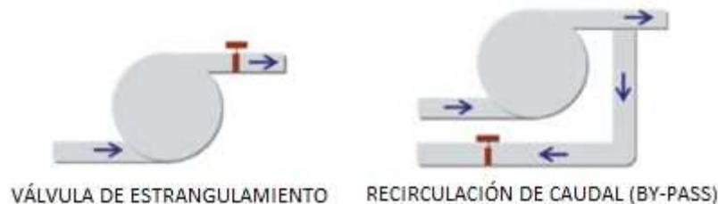
**Figura 19** Sistemas de regulación de caudal en bombeo
