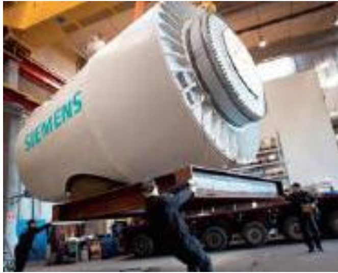
Fig. 5.3. Generador Siemens de 6MW.
